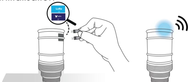
Une LED bleue s'allume brièvement indiquant la mise en route du capteur. Un second flash indique la fin du cycle d'émission.
