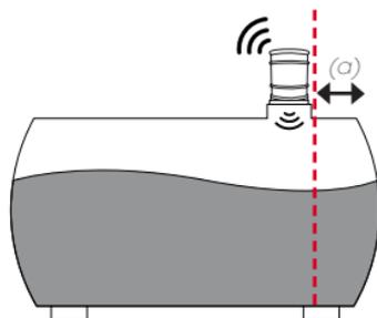
Distance minimale : 20 cm ( $a$ ) d'un des bords de la cuve.
