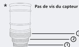
3 pas de vis normés, permettent de fixer le capteur sur toutes les cuves.
