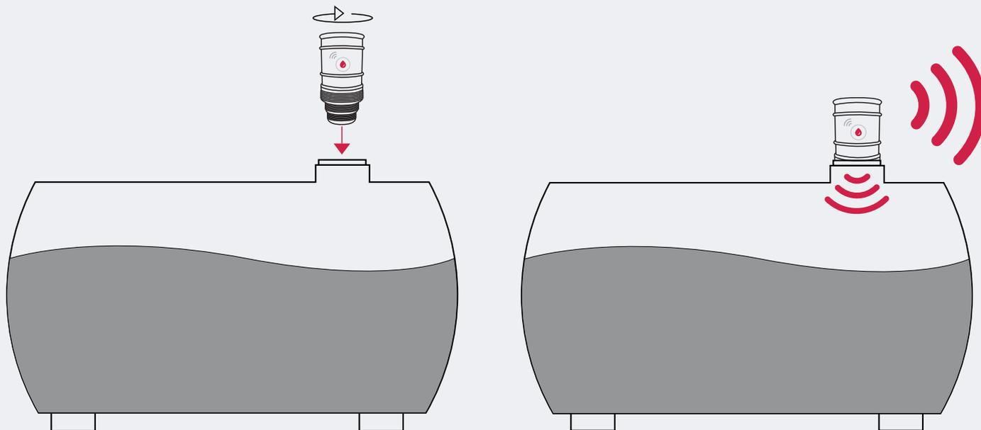
Une installation **simple et intuitive**, le capteur Fuel it se visse à la place **du bouchon de votre cuve**.
