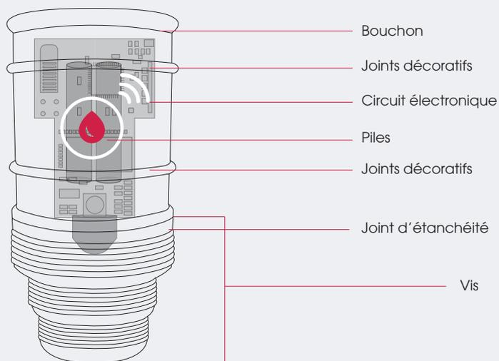
Le capteur Fuel it possède **3 pas de vis**, permettant de s'adapter à tous les types de cuves! Son installation est facile, pour l'activer vous **devez passer l'aimant** (fournit dans le packaging) près du capteur; une **lumière bleue** apparaît : l'**installation est terminée avec succès!**
