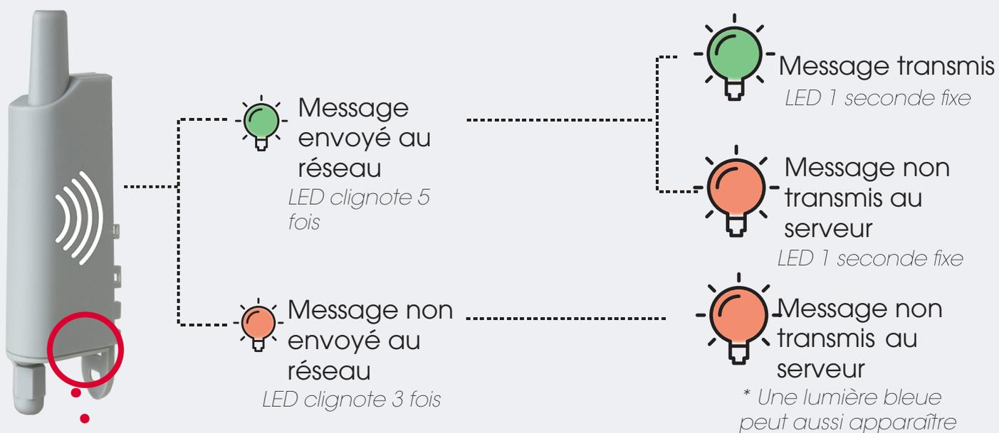
Les voyants lumineux sont visibles en dessous du répéteur et n'apparaissent que lorsqu'un device qu'il répète émet.
