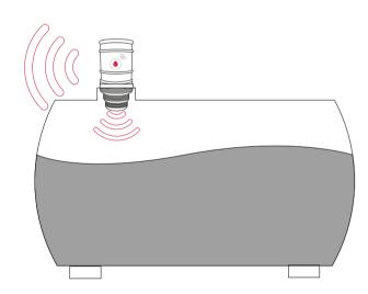
Une installation Plug & play, le capteur fuel it s'installe à la place du bouchon de votre cuve et sera donc forcément accessible.
