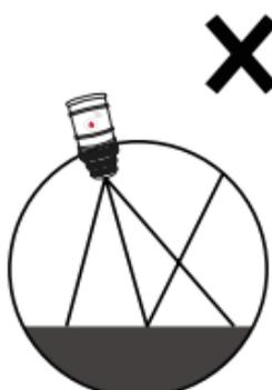
Le capteur doit être installé à la verticale du fioul, sans obstacle pour gêner l'envoi du signal
